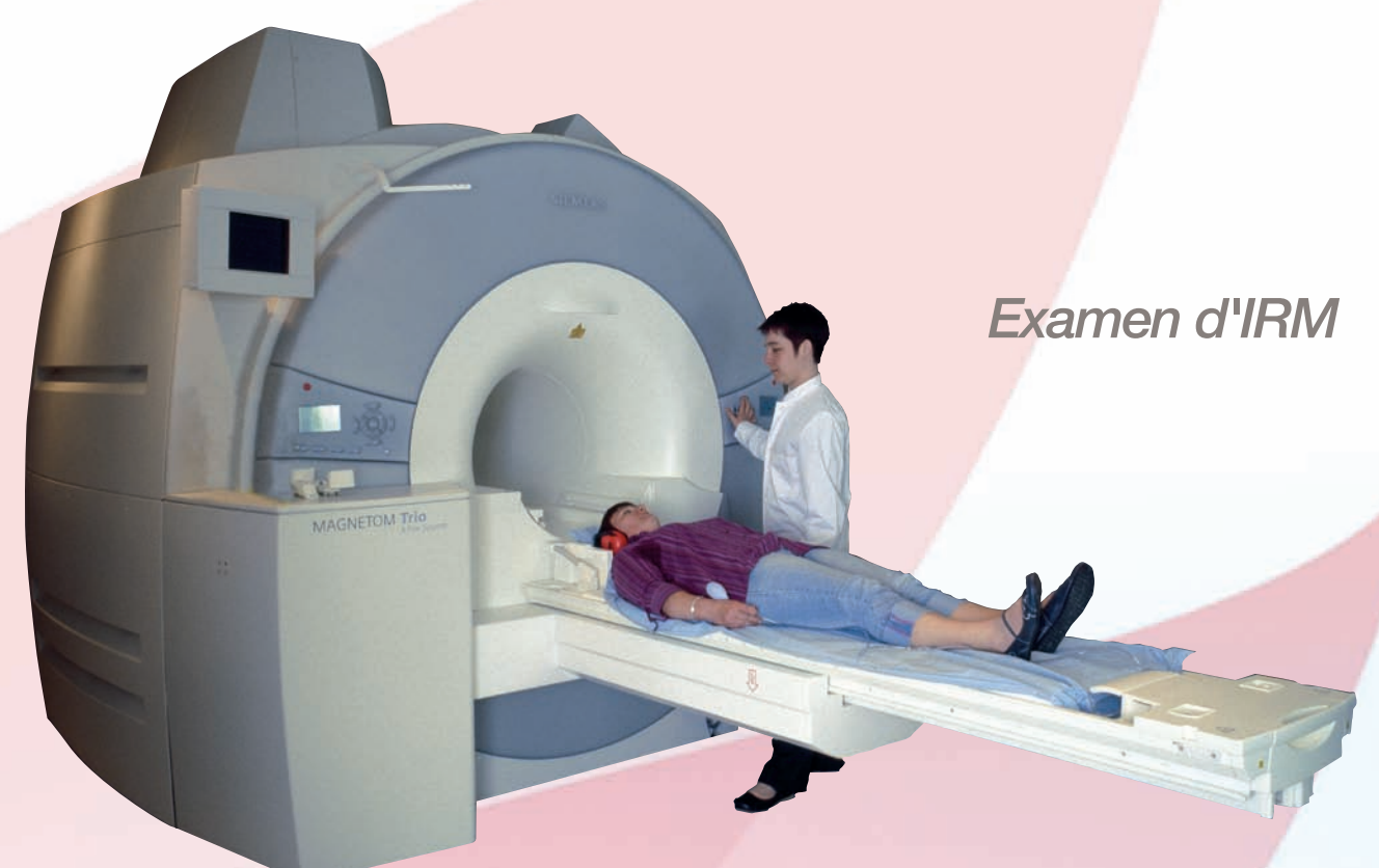
En appliquant un champ magnétique différent en fonction de la position, on peut localiser l'origine du signal.
