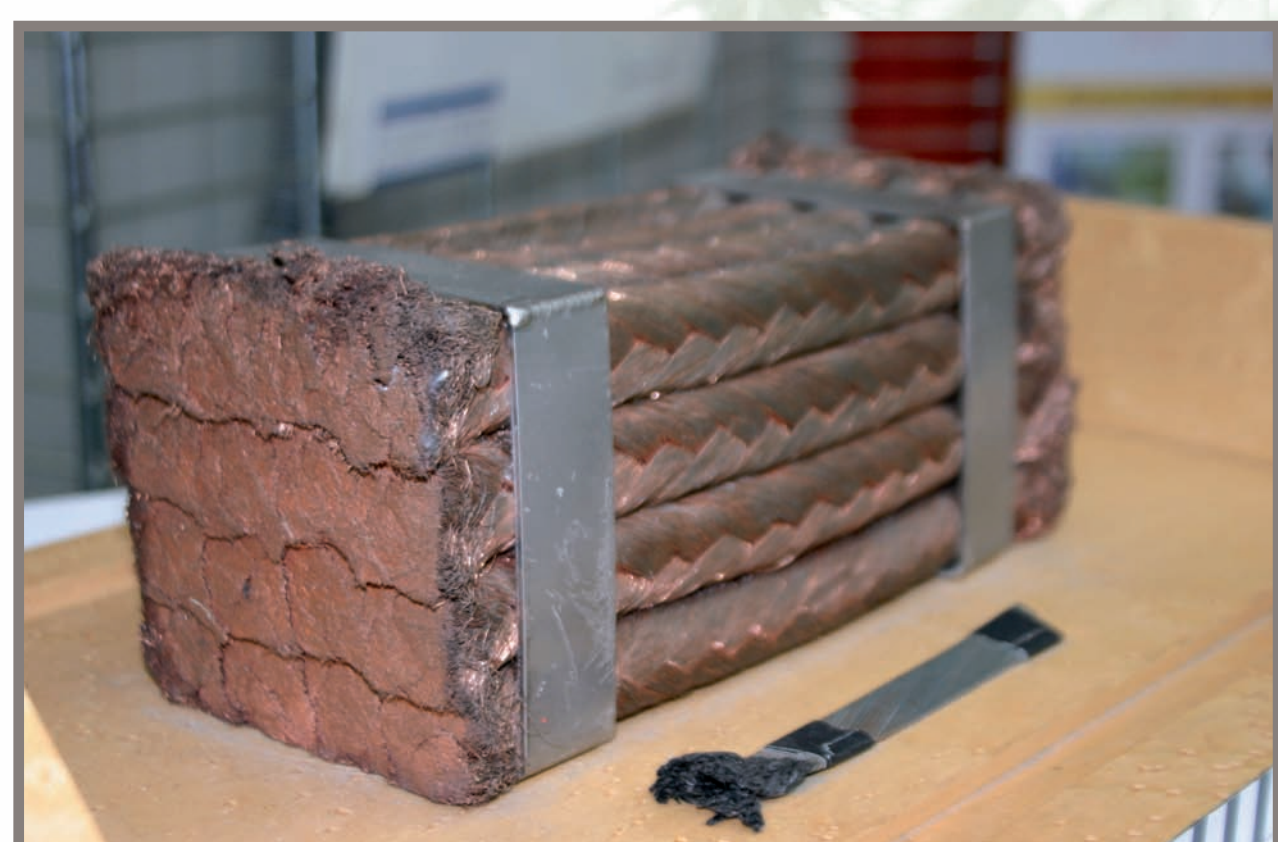
Ces deux câbles peuvent transporter 15 000 ampères : celui de gauche est en cuivre, celui de droite est en alliage niobium-titane, un matériau supraconducteur.
