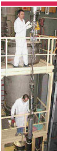
Disposition pour irradiation de matériaux de cuve. ©CEA
